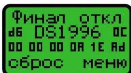
Считав ключ с памятью, дубликатор автоматически определит его тип. Далее в меню записи выберите пункт «Сохранить память», приложите ключ и дождитесь окончания процесса считывания памяти, затем введите имя записи (будет отображаться в базе ключей с памятью).
