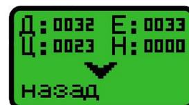
Для просмотра значений счетчиков и лимитов в основном меню выберите «Счетчик» или «Лимит». Значения для ключей каждого из форматов отображаются напротив соответствующих обозначений: Д – Dallas, Ц – Cyfral, М – Metakom, Е – EM-Marine, Н – HID, I – Indala.
